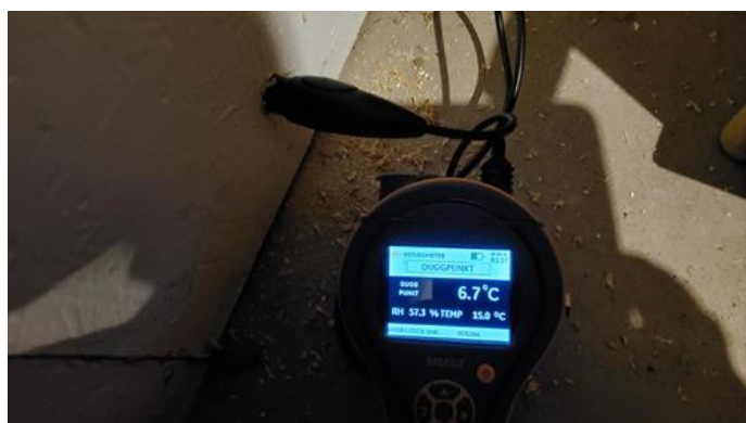
Konstruksjoner (tilfarergulv, himling og vegger). - [Fuktmåling utlektet kjellevegg]
