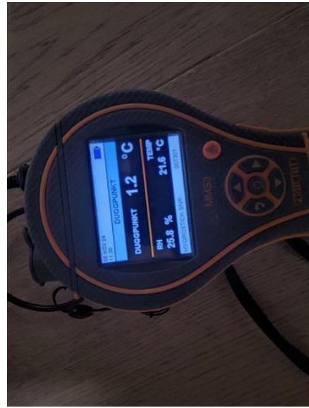
Fukt i tilliggende konstruksjoner - [Fuktmåling bad.]
