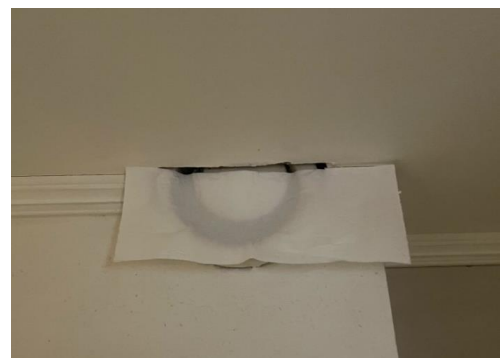
Avtrekksventil bestod papirtesten
