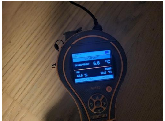
Fukt i tilliggende konstruksjoner - [Fuktmåling bad.]
