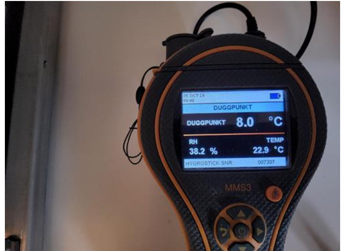
Fukt i tilliggende konstruksjoner - [Fuktmåling bad.]
