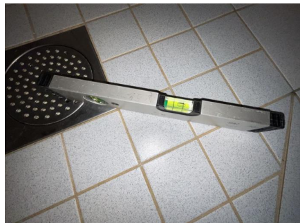
Fallforhold målt i retning sluk.
