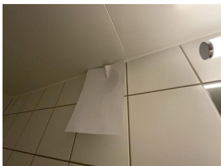
Test med løst ark viste tilfredsstillende avtrekk.
