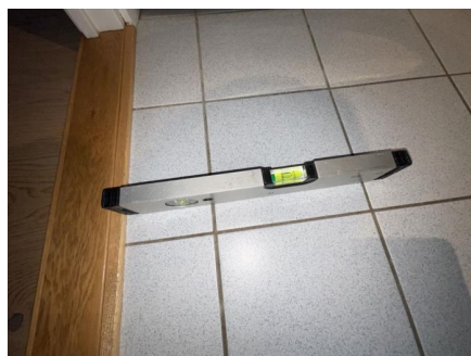
Fallforhold målt i retning sluk.
