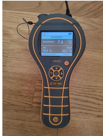
Fukt i tilliggende konstruksjoner - [Fuktmåling]
