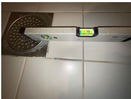
Fallforhold målt i retning sluk.
