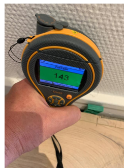
Fuktmåling fra tilliggende entre mot våtsone uten avvik.
