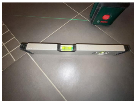
Fallforhold målt i retning sluk.
