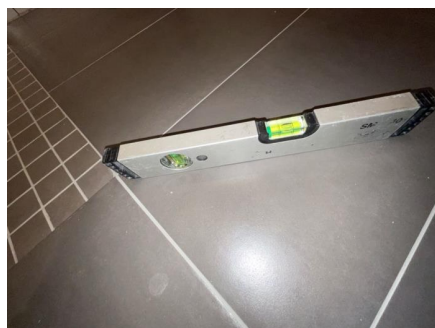
Fallforhold målt i retning sluk.
