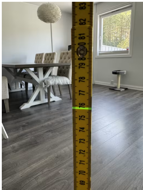
Skjevheter i stue er kontrollert med krysslaser.
