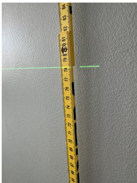
Skjevheter i stue er kontrollert med krysslaser.
