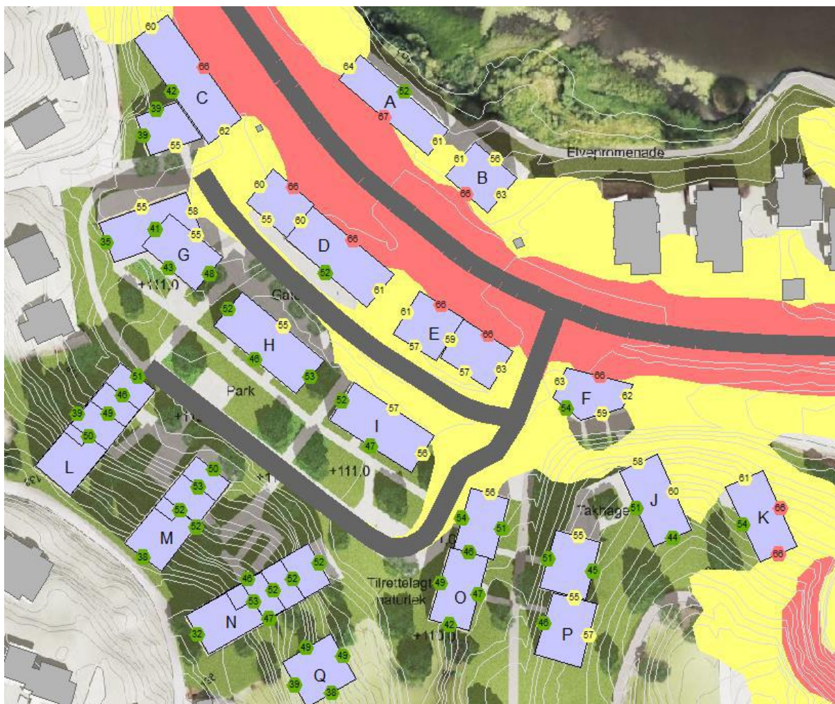
Figur 8. Støysoneskart, 1.5 m over terreng. Høyeste fasadenivå på hver fasade er markert. Alle tall i Lden
